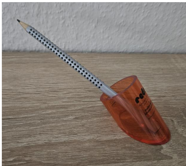
Bild 10: Kleinteiletester nach EN 1130-2 – Der Bleistift gilt als nicht verschluckbar, weil er aus dem Zylinder herausragt.
